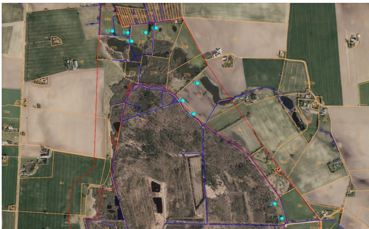
Figur 17: Oversigtskort med angivelse af udtagningspunkter for jordbundskarteringer (lyseblå markering og nr.). Randzone (rød streg), matrikelgrænse (orange streg og nr.) samt vandløb og grøfter (blå streg).
